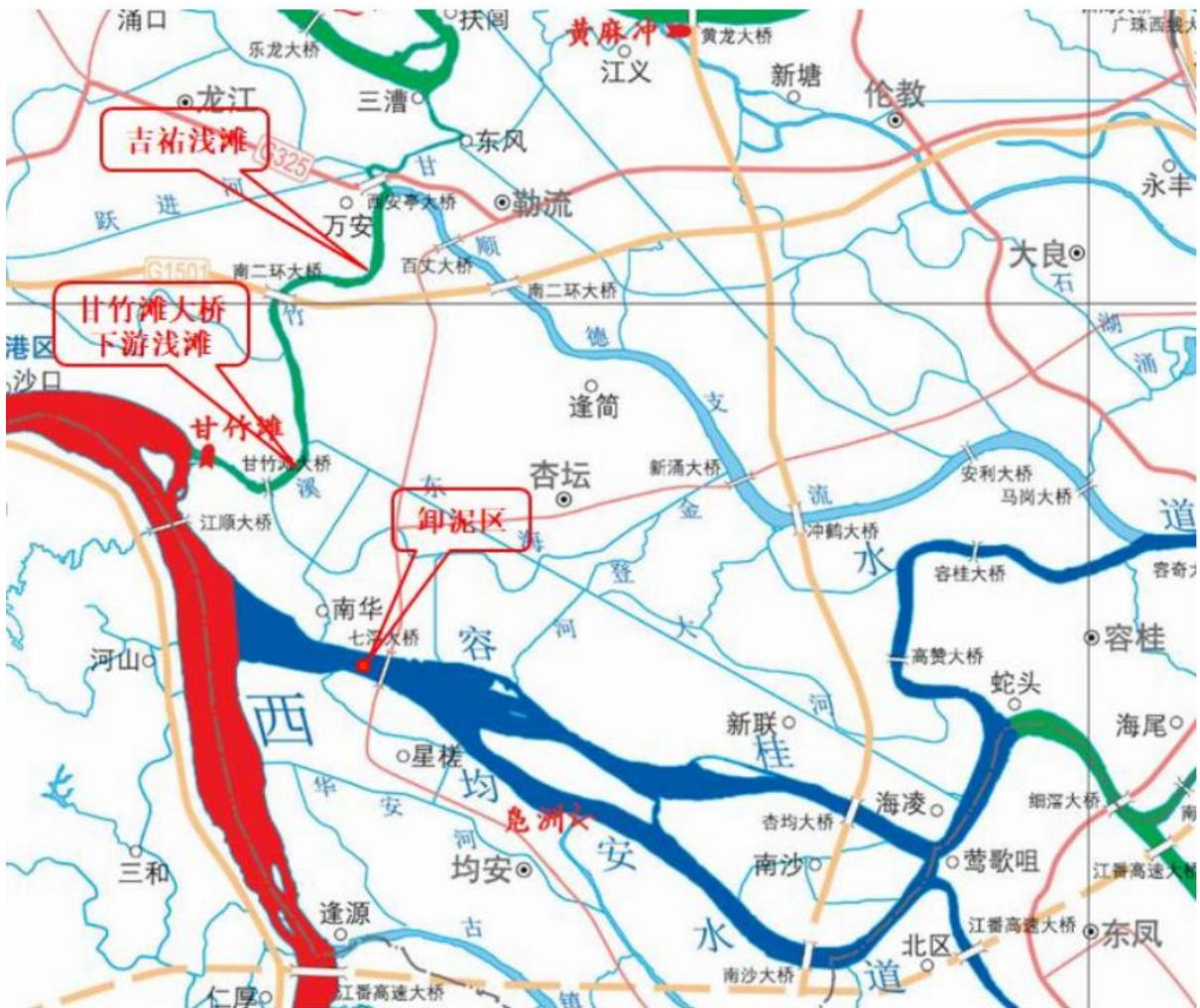
1.3 项目内容：本工程维护疏浚位于甘竹溪水道吉祐浅滩、甘竹溪水道甘竹滩。甘竹溪水道等级为内河限制性IV级航道，本次维护包括甘竹滩大桥左岸河段以及吉祐河段左岸两处浅滩，维护里程合计 1.51km，维护尺度为 2.5×35×130m。
